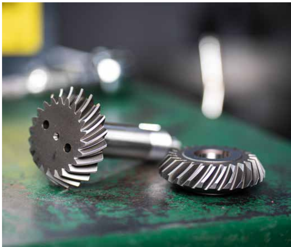
Les engrenages coniques PTO de 60 degrés pour un véhicule militaire terrestre.
