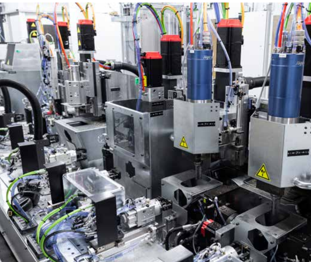
Alle sieben Sekunden fällt ein fertiger Schlüssel aus der Anlage.
