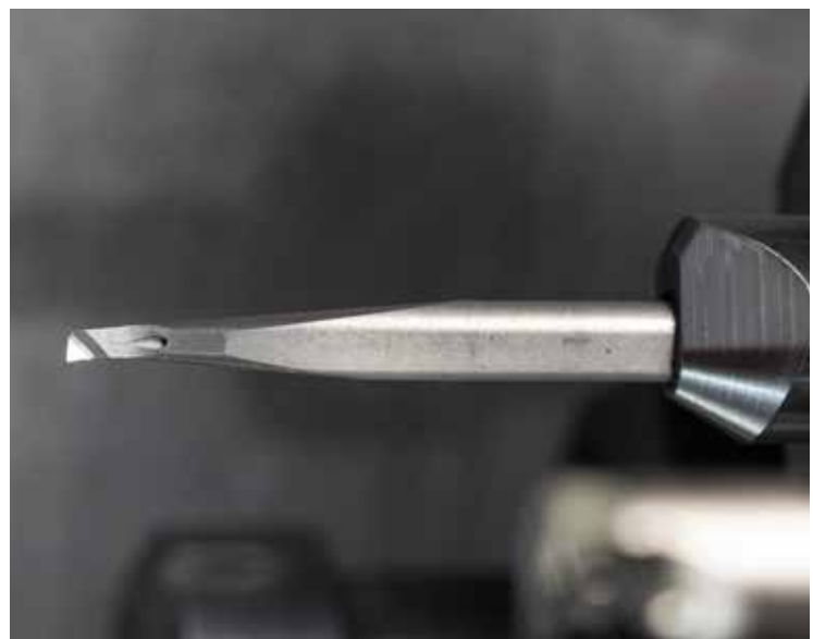
Beim Innenausdrehen kommt das PKD-bestückte Supermini-System zum Einsatz.
