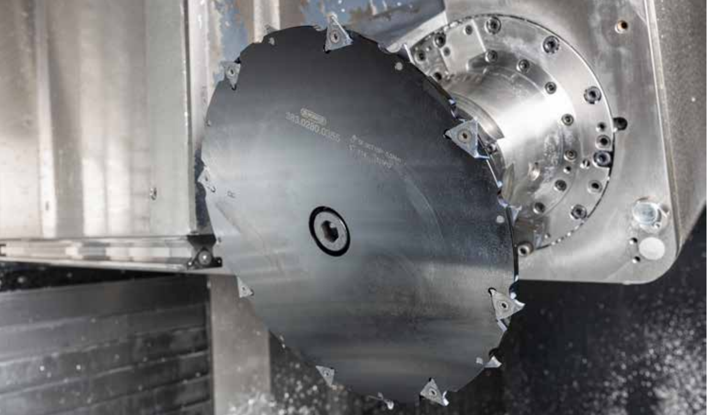
Den Sonder-Scheibenfräser mit 280 mm Durchmesser lieferte HORN innerhalb von vier Wochen.
