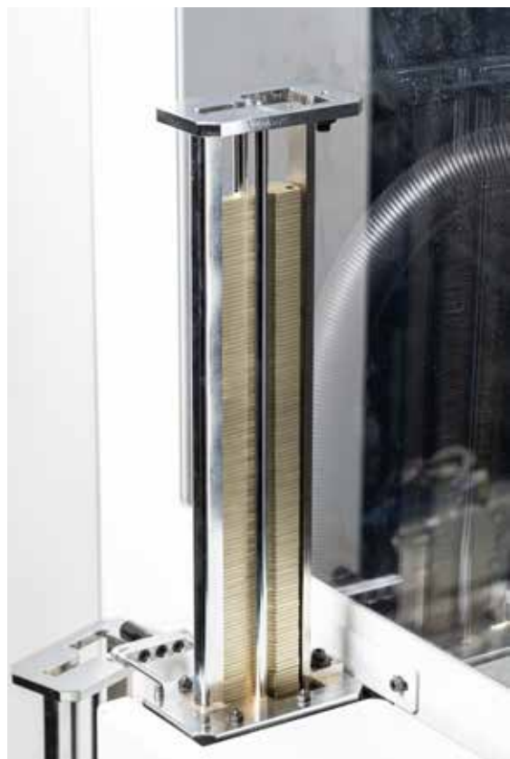
Die Zuführung der Rohlinge erfolgt über ein Magazin oder als Schüttgut.
