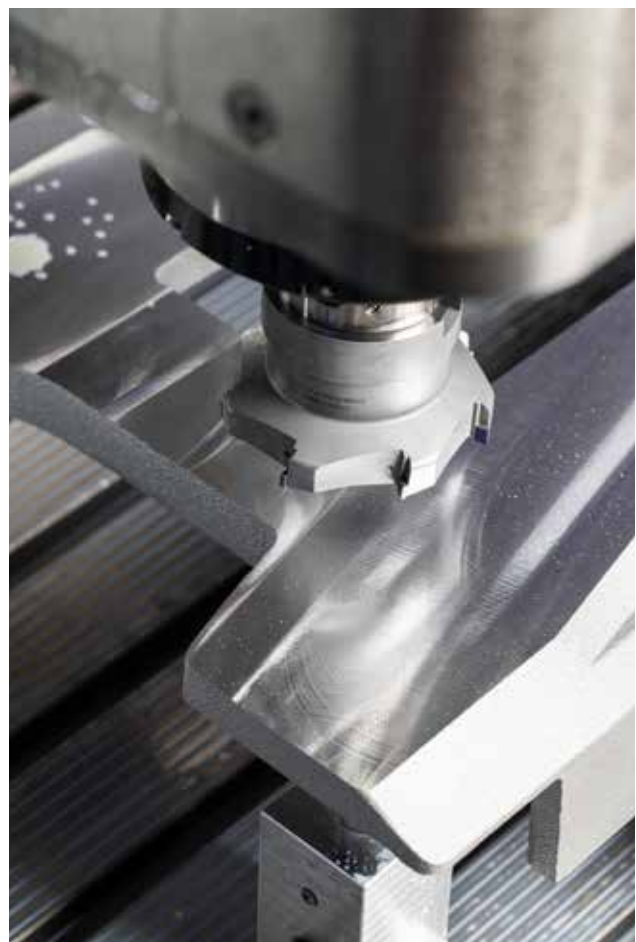
Der Einsatz des HORN-PKD-Schruppfräfers verkürzt die Bearbeitungszeit um die Hälfte und sorgt für hohe Standzeiten.
