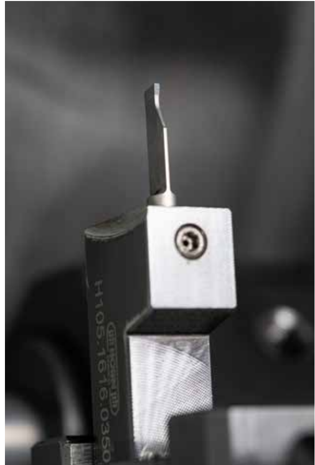
Abstechen mit 1 mm Schneidbreite: HORN setzt als Basis auf System Supermini.
