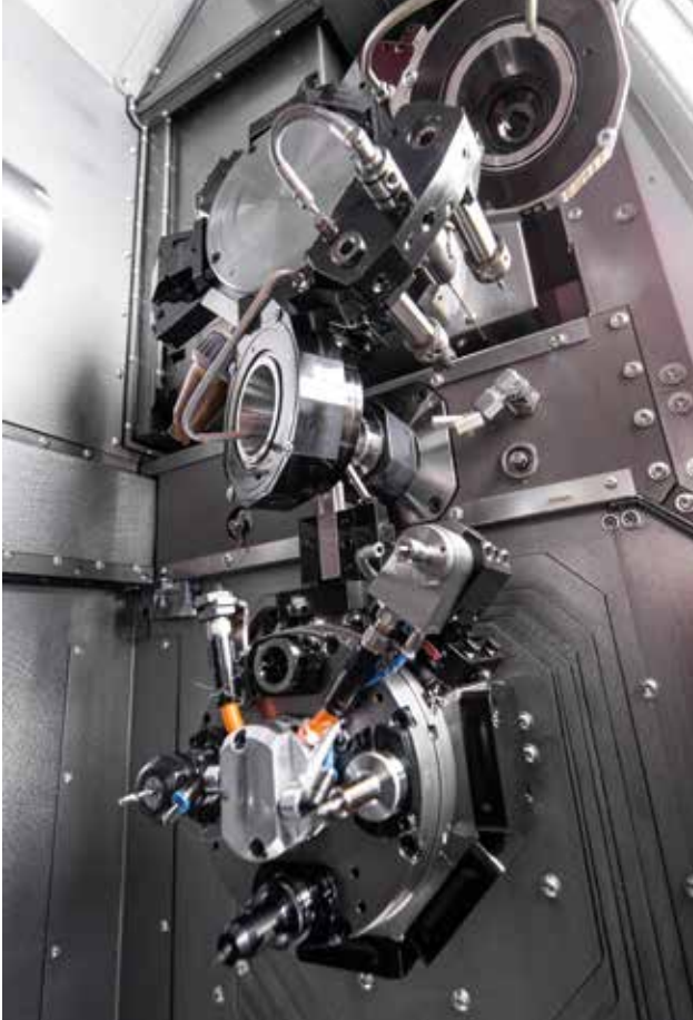
Die Kinematik des Langdrehers ermöglicht eine effektive und zeitgleiche Bearbeitung mit zwei, drei oder vier Werkzeugen.
