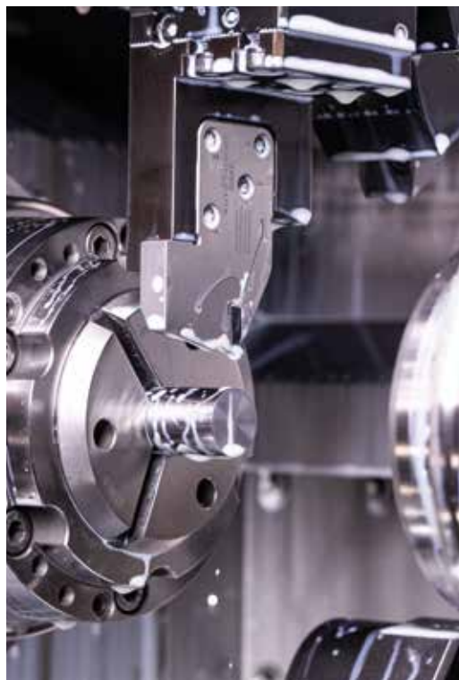
Beim Anstechen setzt man bei RICH Präzision auf das modulare Stechsystem mit der Schneidplatte S100.
