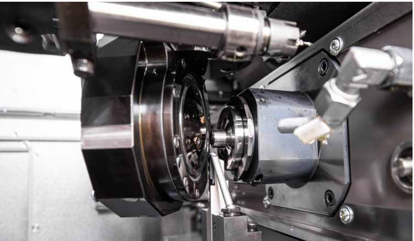
Für die Bearbeitung von Titanlegierungen kommt die Sorte IG35 zum Einsatz.
