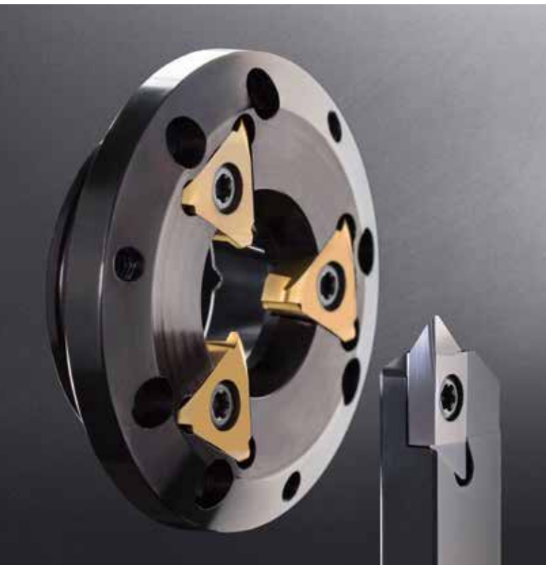
Das Highspeed-Wirbeln ermöglicht einen kontinuierlichen Schnitt durch parallele Drehbearbeitung.
