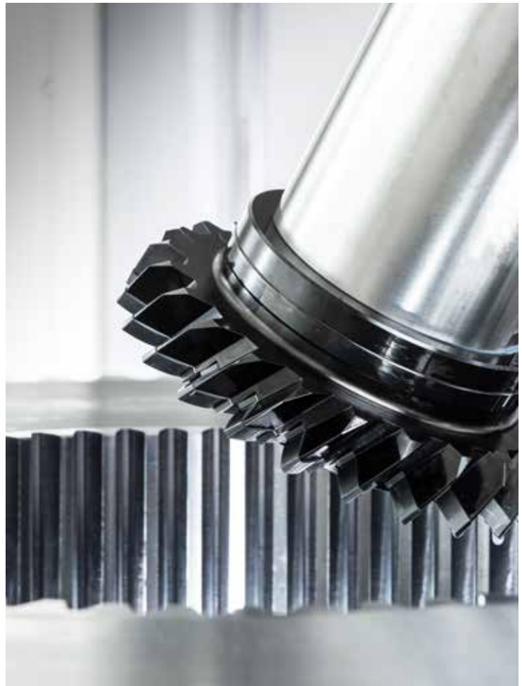
Für größere Module bietet HORN auch Wälzschälssysteme mit Wechselplatten.
