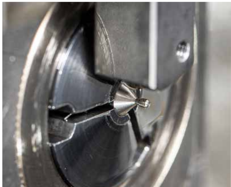
Drehen des Gewindes M1,6 x 0,35 mit dem System S274.
