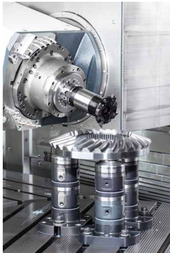
Für die wirtschaftliche Schruppbearbeitung von Zyκλο-Palloid-Verzahnungen entwickelte HORN das Frässystem M279.
