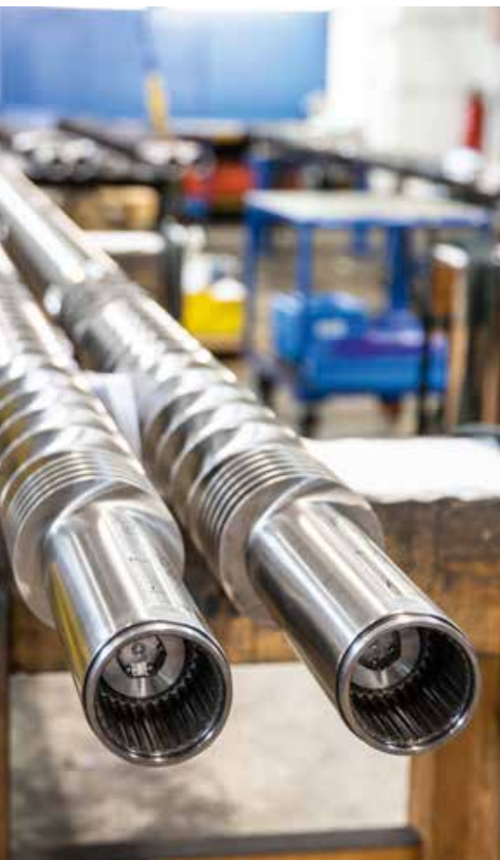
Modulare Bauweise: zwei im Aufbau befindliche Extruderschnecken. Vorne sind die Muffen erkennbar.
