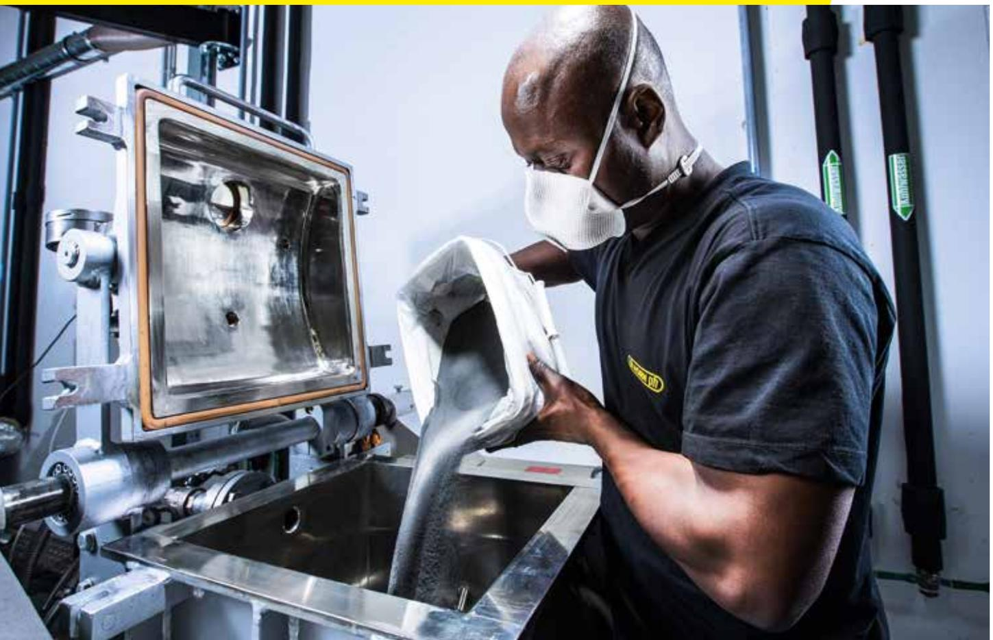
Der Herstellprozess einer Schneidplatte beginnt mit dem Mischen und Aufbereiten von pulverförmigen Hartmetalllegierungen.
