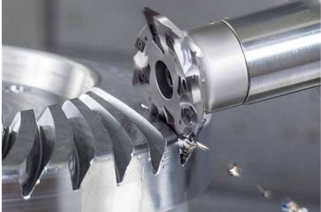
Ab Modul 4 bis Modul 30 bietet HORN Verzahnungslösungen für Prototypen sowie Klein- und Mittelserien auf universellen Bearbeitungszentren.
