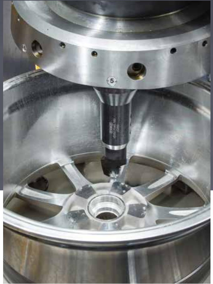
Drehen der Speichen im unterbrochenen Schnitt.
