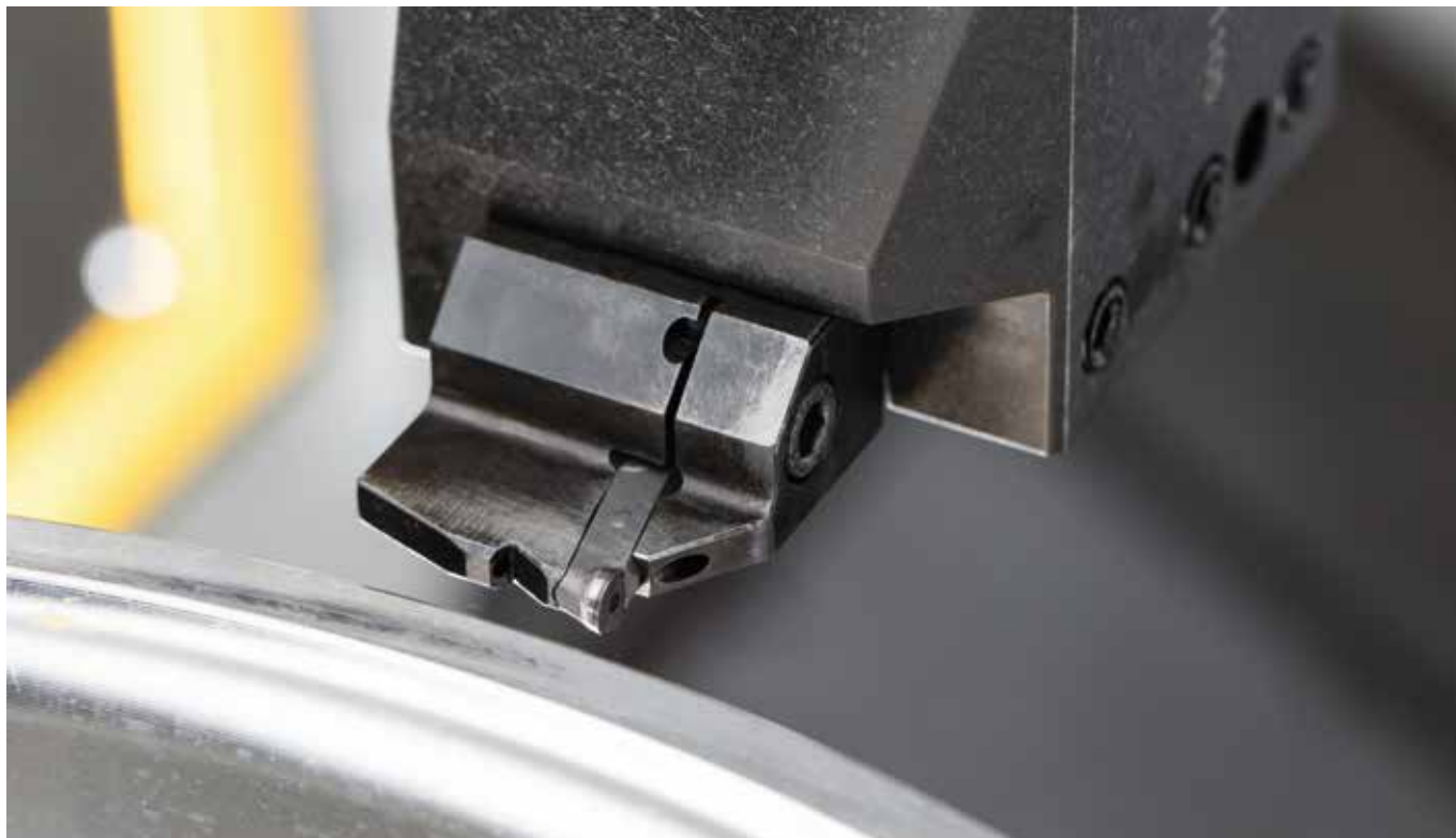
Drehen des Felgenhorns mit dem System S29F.
