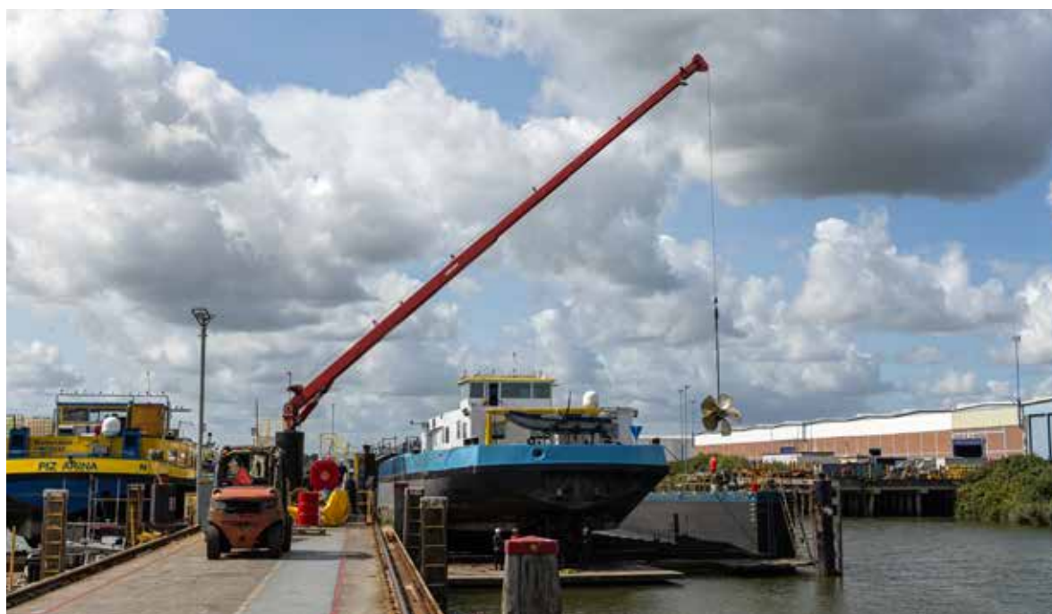
Zum Wechsel des Propellers bleiben die Schiffe im Schnitt nur fünf Stunden in der Werft.
