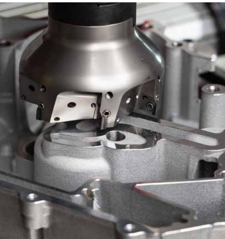
Das HORN-Frässystem DTM sorgt mit den PKD-Schneideinsätzen für hohe Oberflächengüten auf den Aluminium-Bauteilen.
