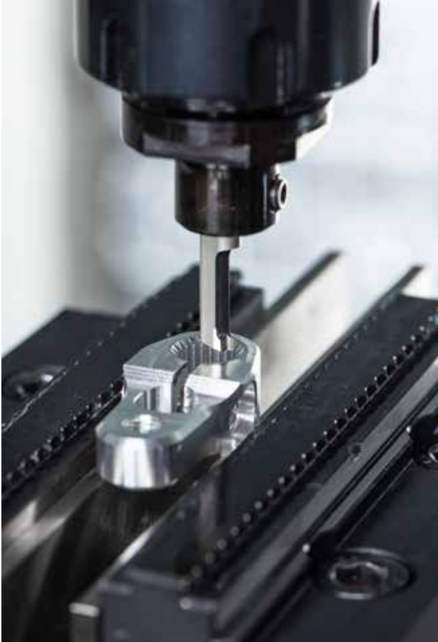
Für das Stoßen von Steckverzahnungen setzt Midy auf den Werkzeugtyp Supermini.
