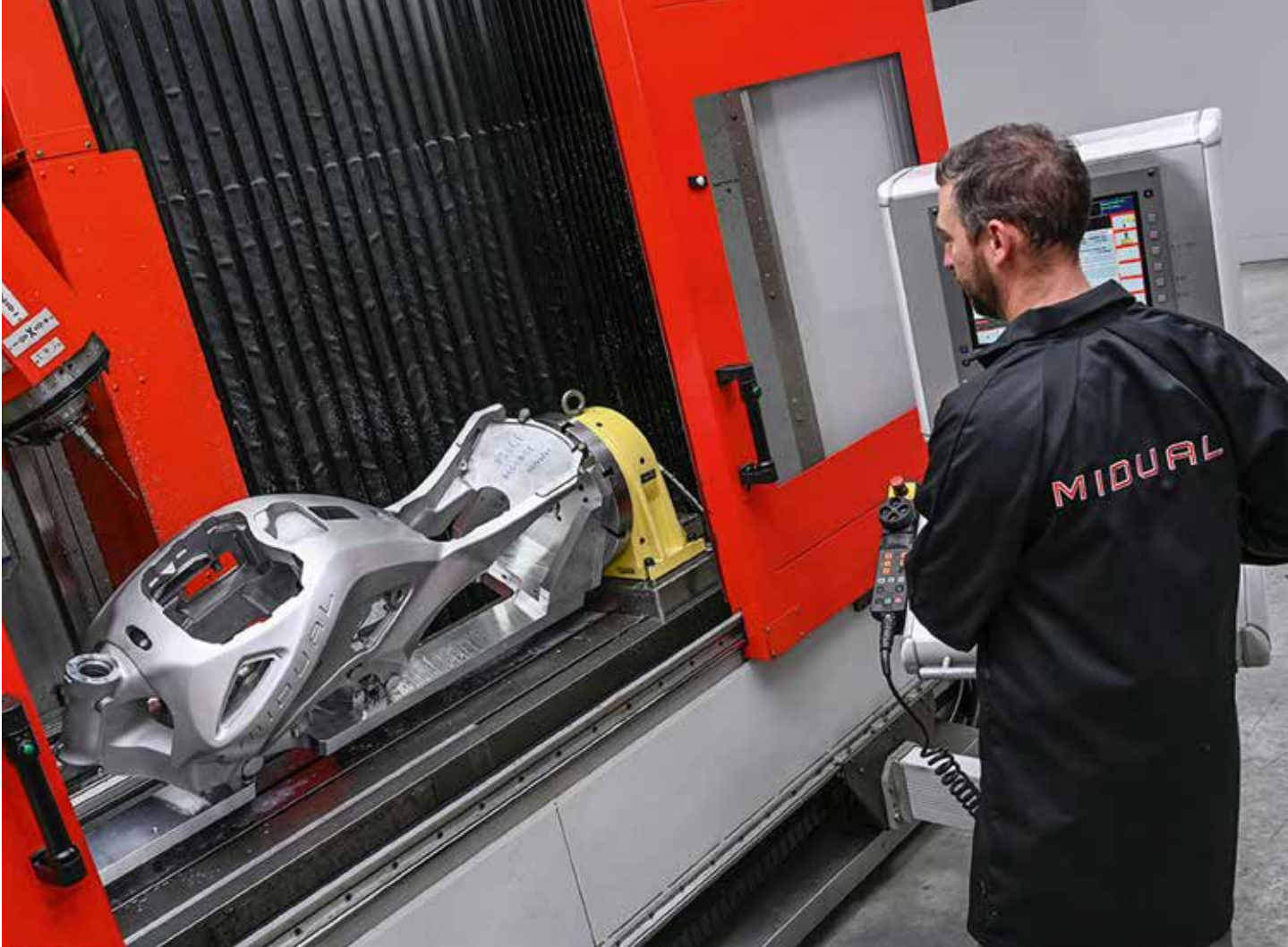
Nach dem Guss geschieht die spanende Bearbeitung auf einem CNC-Bearbeitungszentrum.
