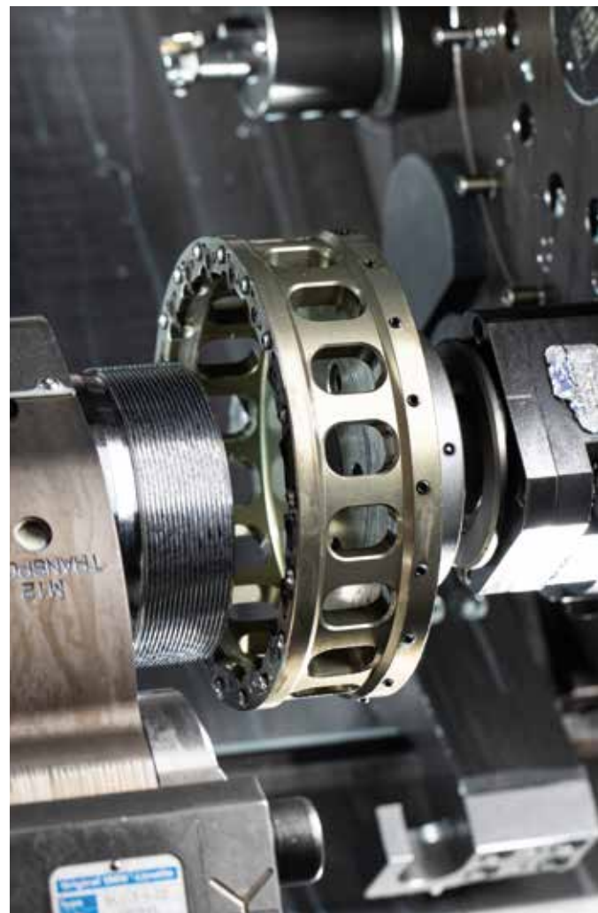
Die Umstellung auf den Glockenfräser ergab eine hohe Zeiteinsparung und steigerte die Prozesssicherheit.
