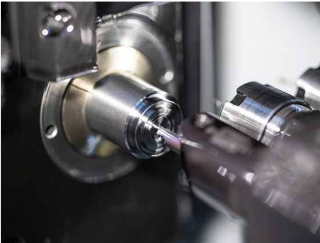
Axialstechen des Medizintechnik-Bauteils mit dem System Supermini Typ 105.
