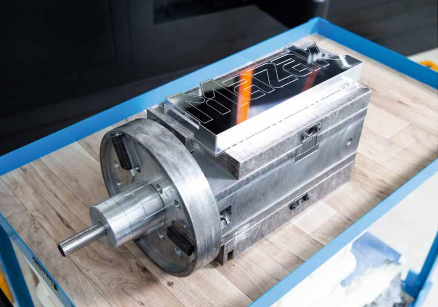
Die von Mazak entwickelte massive Spannvorrichtung.
