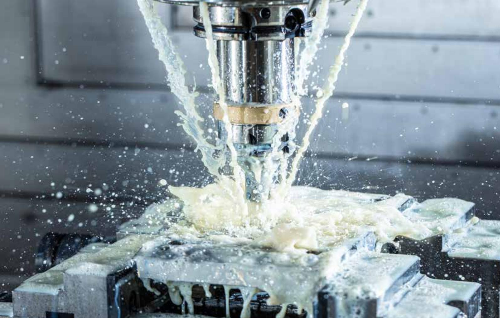
Für die produktive Herstellung von Nuten in kubischen Werkstücken entwickelte HORN Werkzeuge für das Verfahren Speed-Forming.
