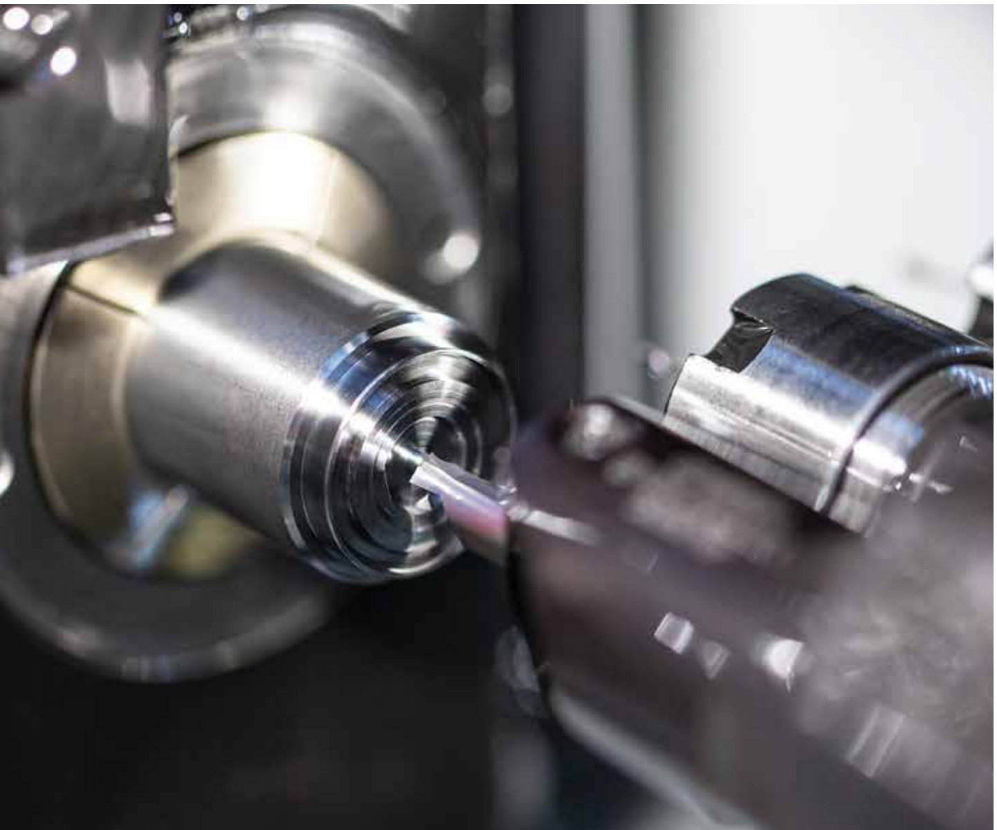
Axialstechen des Ventildeckels mit dem Supermini Typ 105.
