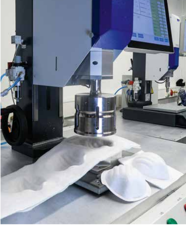
Für die Herstellung von medizinischen Masken kommt das Ultraschallschweißen von Weber Ultrasonics zum Einsatz.
