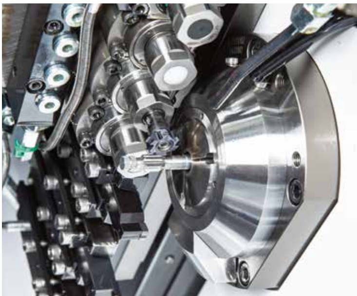
Verzahnungsfräsen mit dem System 613.
