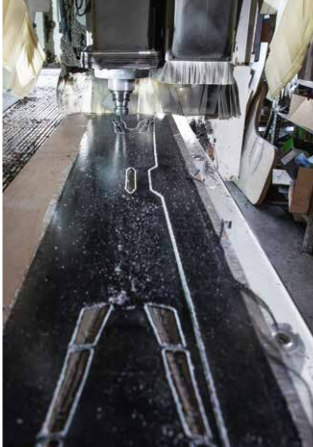
Fräsbearbeitung der CFK-Matten. Die ausgefransten Kanten stammen von dem Schutzgewebe.
