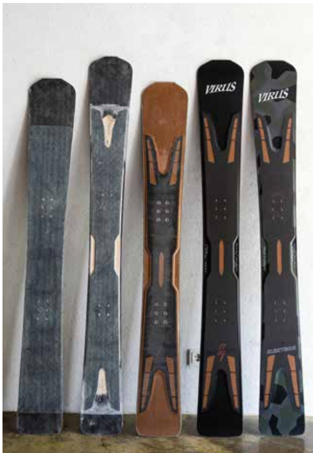
Die einzelnen Produktionsschritte im Überblick: Links der laminierte und besäumte Rohling. Rechts das fertig lackierte Snowboard.
