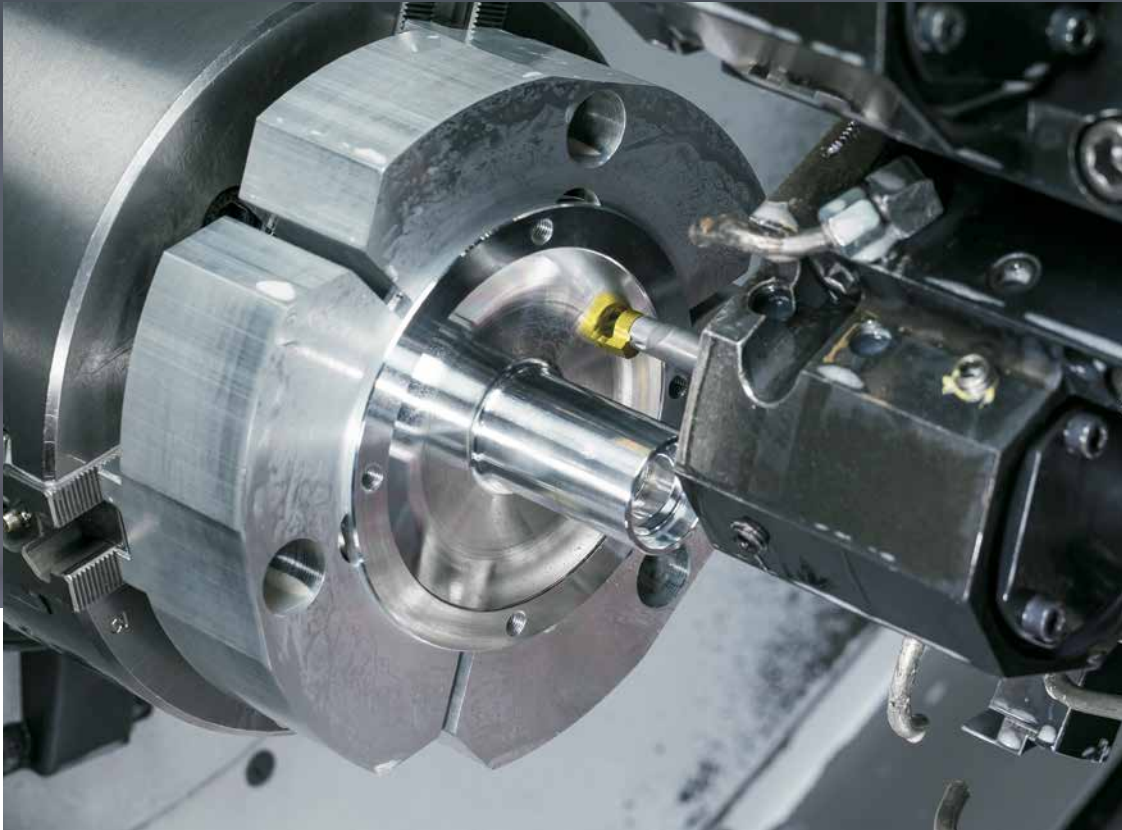
Schichten der Mantelfläche des kleinen Durchmessers und der konkaven Planfläche mit dem Axial-Stechwerkzeug vom Typ Mini R114.
