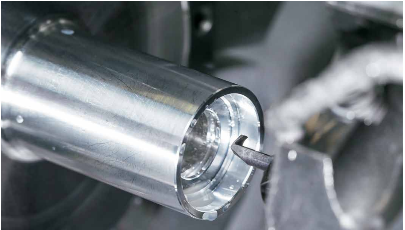
Supermini Typ 105 bei der Bearbeitung des 1 mm breiten Inneneinstichs.
