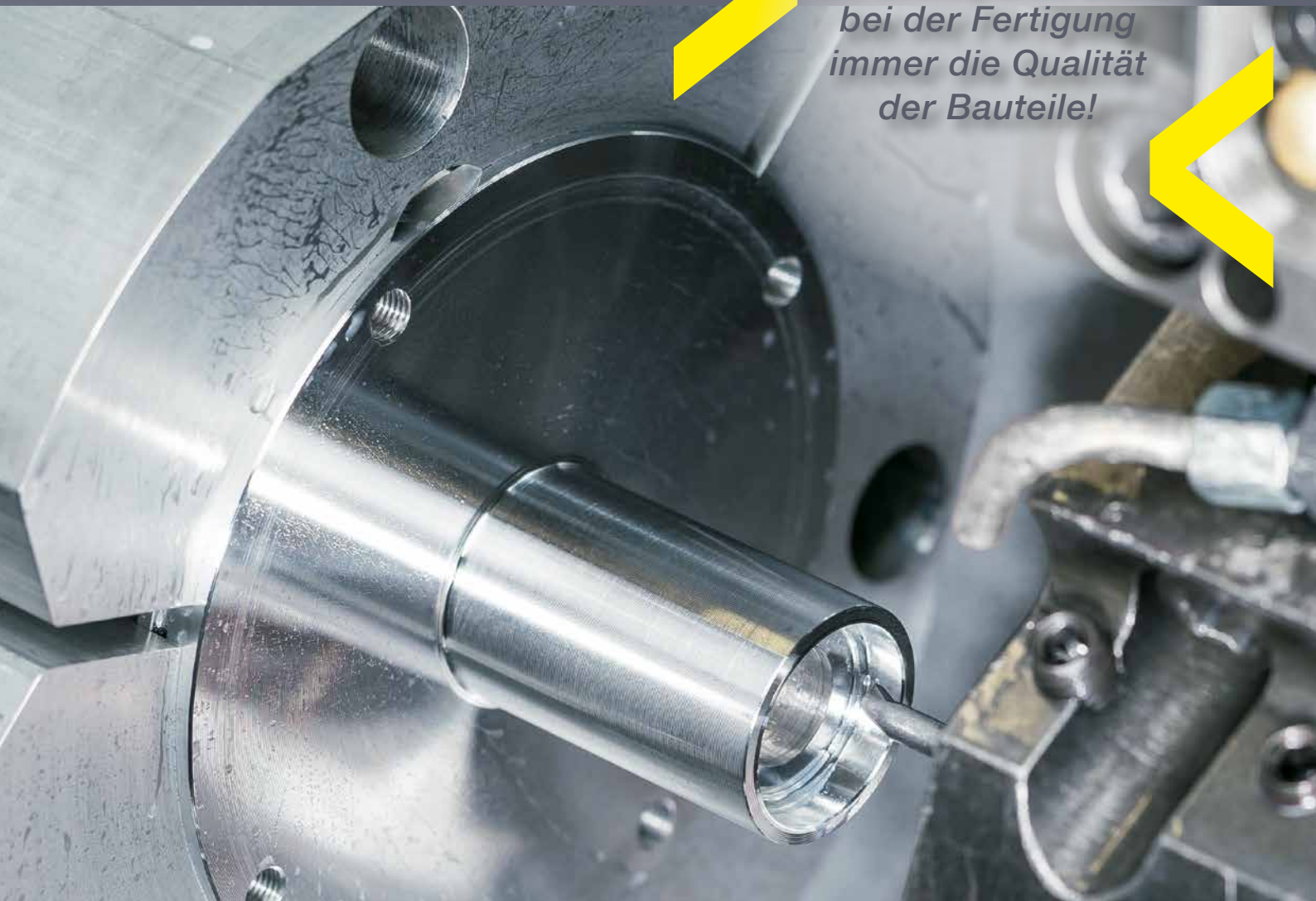
Ausdrehen des Innendurchmessers mit dem System Supermini, Typ 105.
