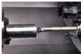
Der Bereich der optimalen Dämpfung ist sehr schmal. Um die optimale Dämpfung zu erreichen sind unter Umständen mehrere Einstellvorgänge durchzuführen.
