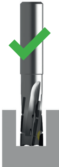
Trochoidalfräsen Trochoidal milling
