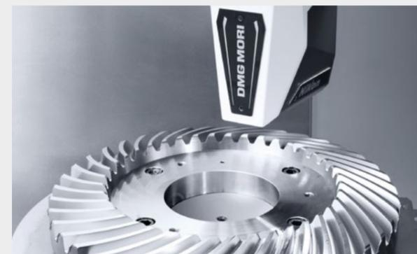
In-Prozess-Messen, taktil mittels Messtaster und **Neu:** optisch über Laserscanner – Genauigkeit analog einer Koordinatenmaschine.
