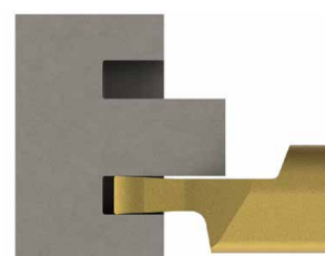
Axialeinstechen Face Grooving
