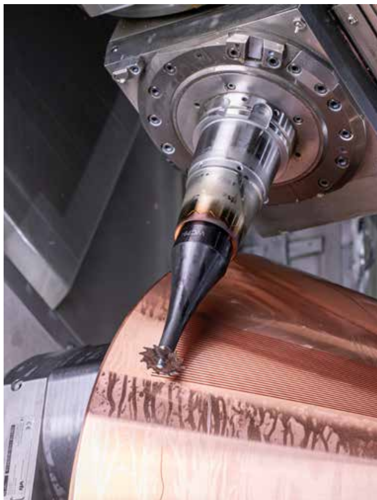
Le porte-outil de base en acier est un support parfaitement équilibré. Cela garantit un usinage sans vibrations malgré le long porte-à-faux.
