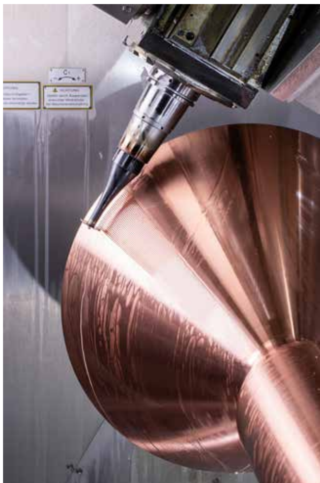
L'outil fraise plusieurs centaines de mètres de rainures de refroidissement dans la chambre de combustion.
