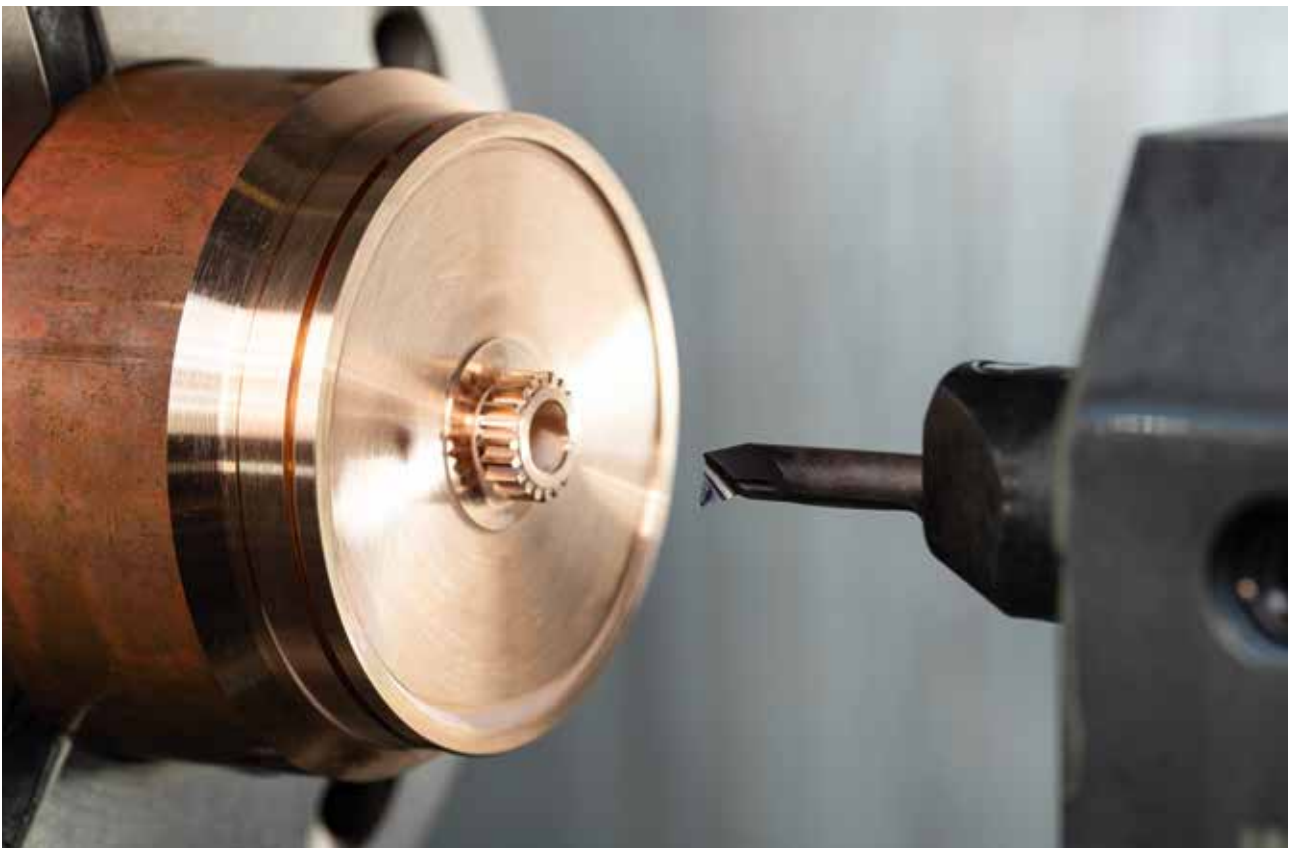
Alésage intérieur du trou central avec un outil HORN-Supermini.
