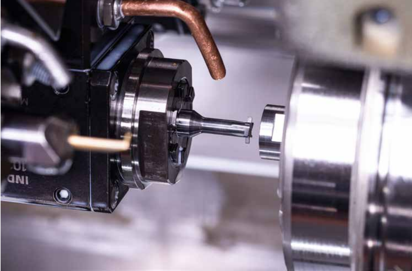
Rainurage avec le système de fraisage circulaire en carbure monobloc DC.
