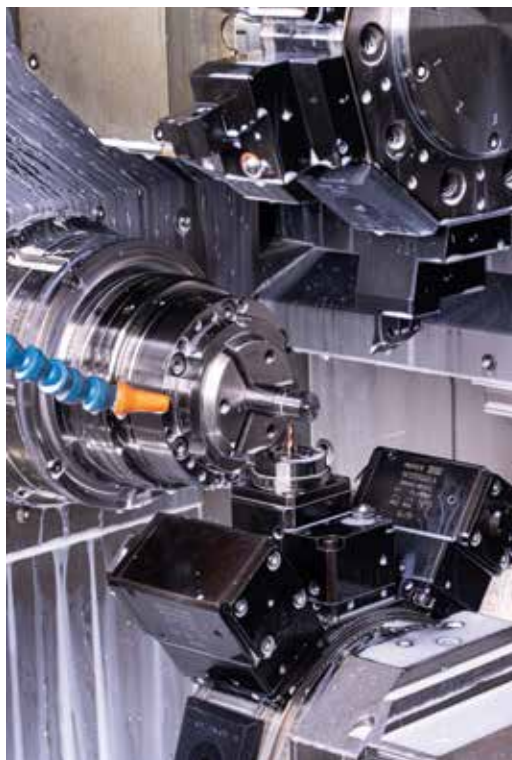
Fraisage des méplats de serrage avec le système DS HORN .
