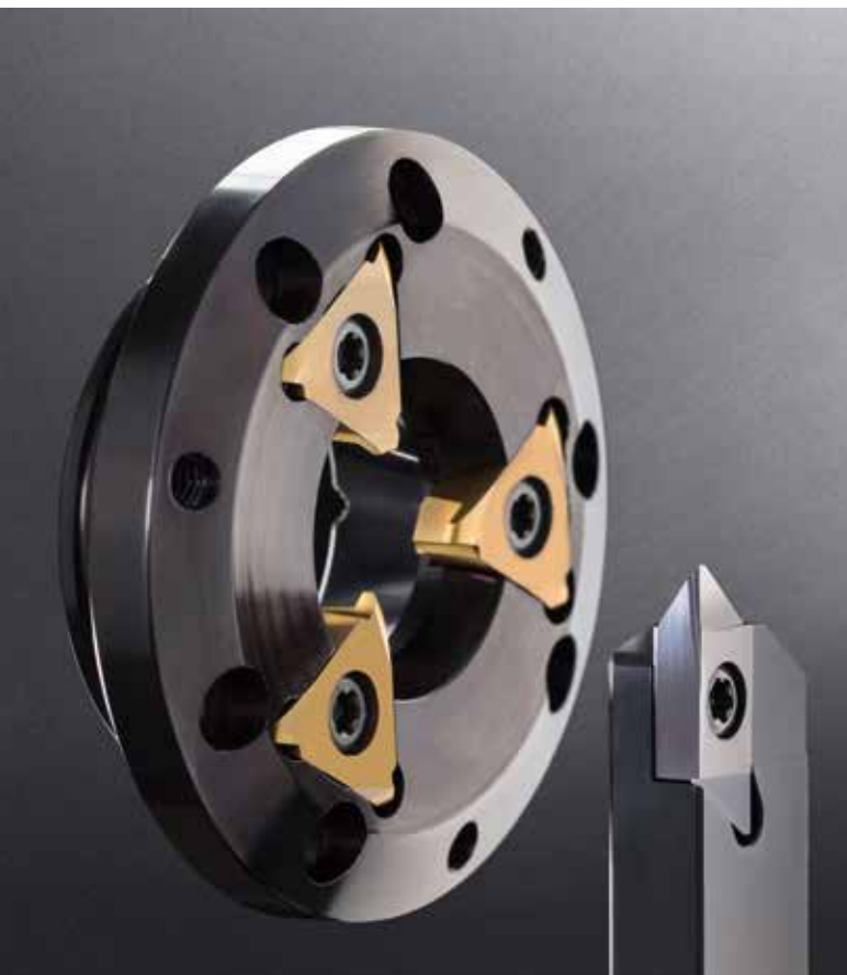
Le tourbillonnage à grande vitesse permet d'obtenir une coupe continue grâce à un usinage rotatif parallèle.
