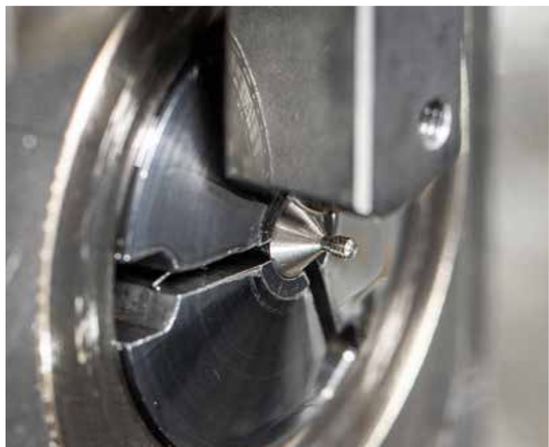
Tournage du filetage M1,6 x 0,35 avec le système S274.
