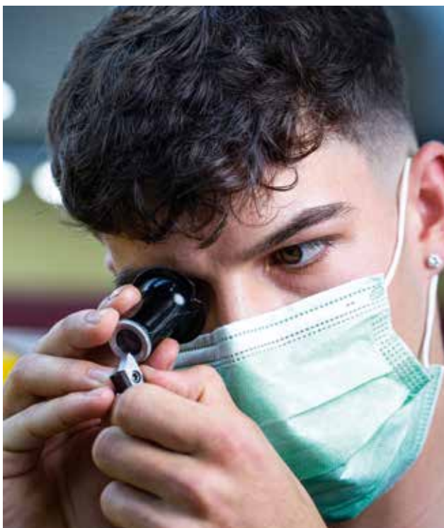
Contrôle de coupe après 22 500 plongées.
