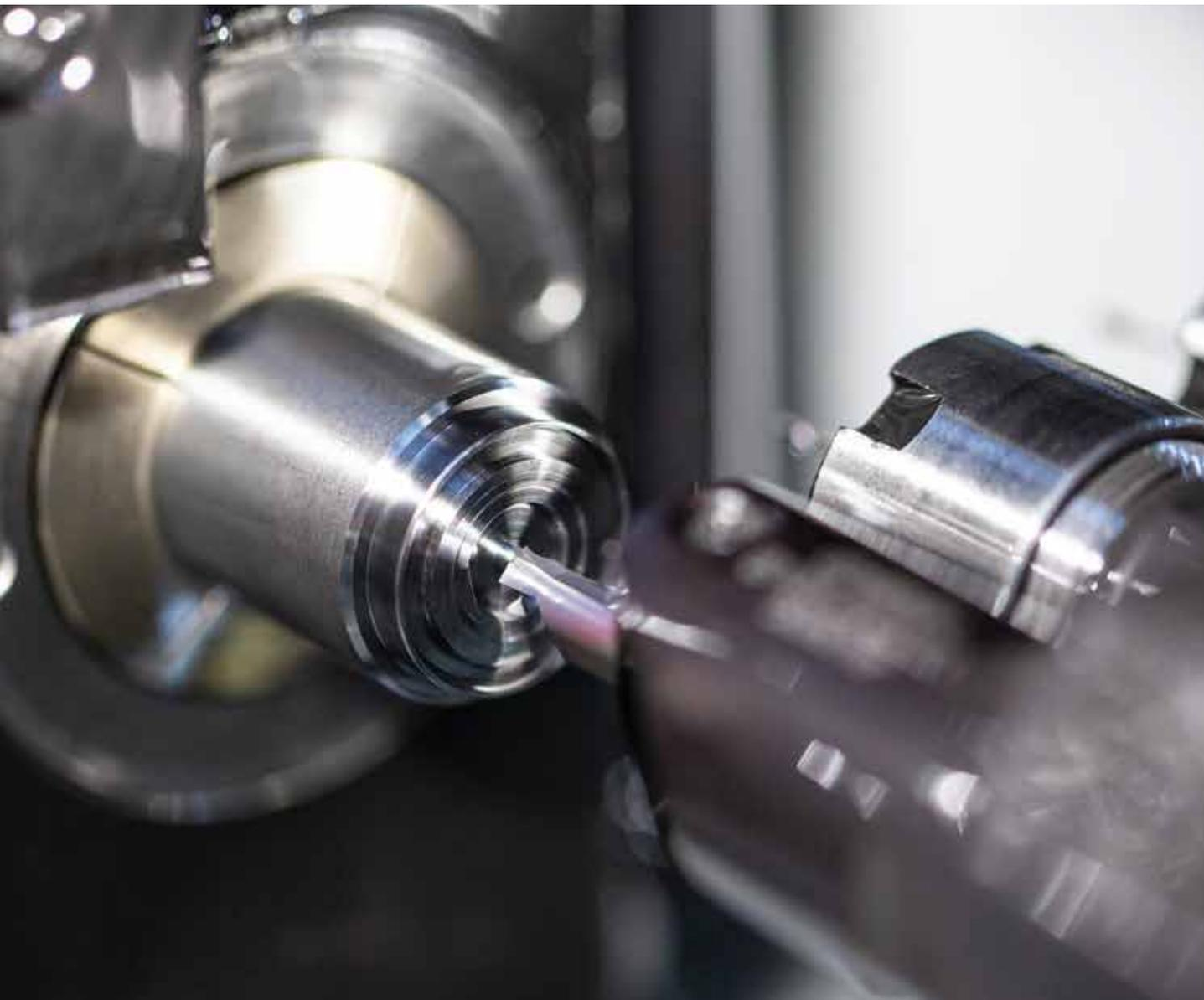
Plongée axiale du couvercle de valve avec le système Supermini, type 105.
