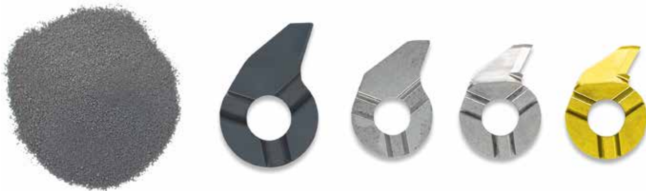
Les étapes de process, de la poudre à la plaquette de coupe.
