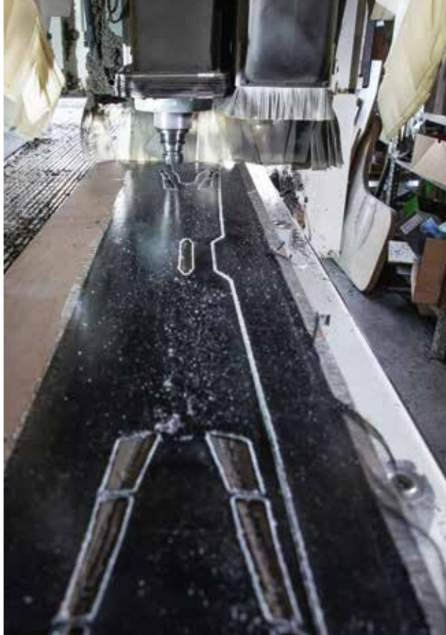
Fraisage des couches en PRFC. Les bords effilochés proviennent du tissu de protection.
