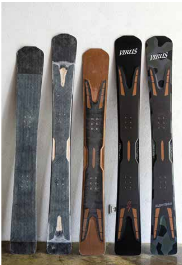
Aperçu des différentes étapes de production : à gauche, la pièce brute laminée et taillée. À droite, le snowboard laqué fini.
