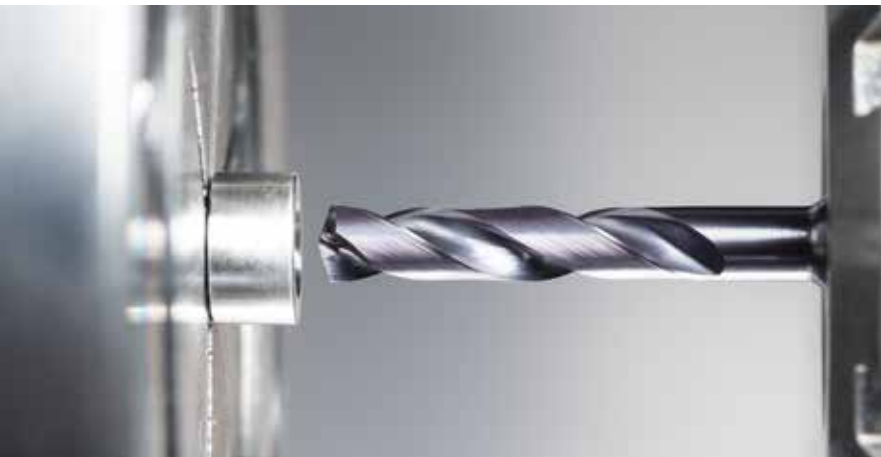
Alésage de la tête de vis avec le système HORN DD.
