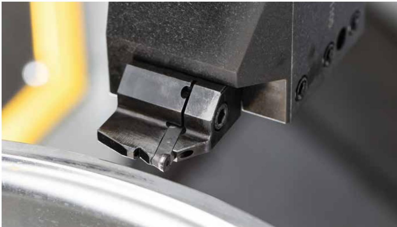
Tournage du rebord de la jante avec le système S29F.
