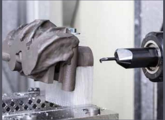
Alésage d'un étrier de frein avec un système Supermini de type 105.
