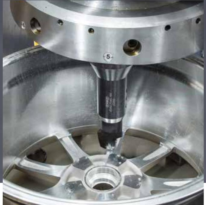
Tournage des rayons au cours d'une coupe interrompue.
