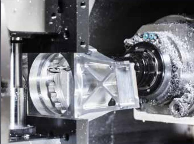
Fraisage d'un porte-fusée à l'aide du système DSA.
