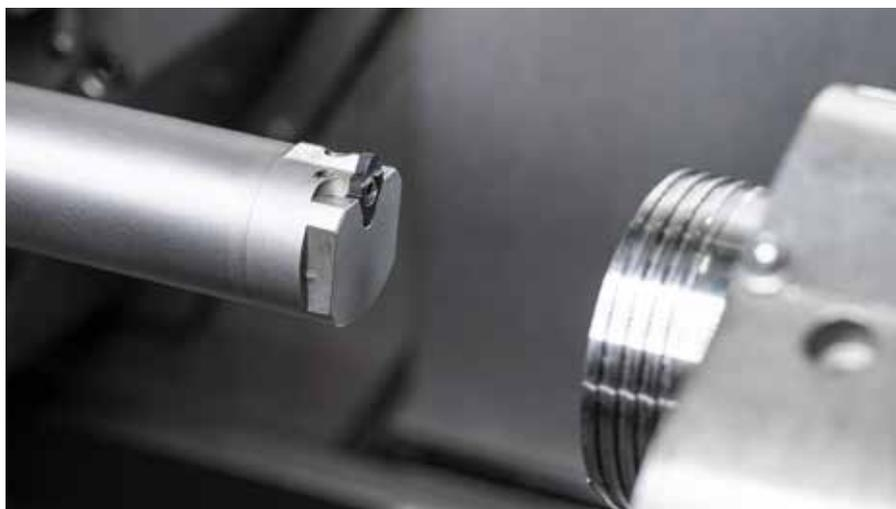
HORN 依靠 117 系统对花键进行插齿加工。
