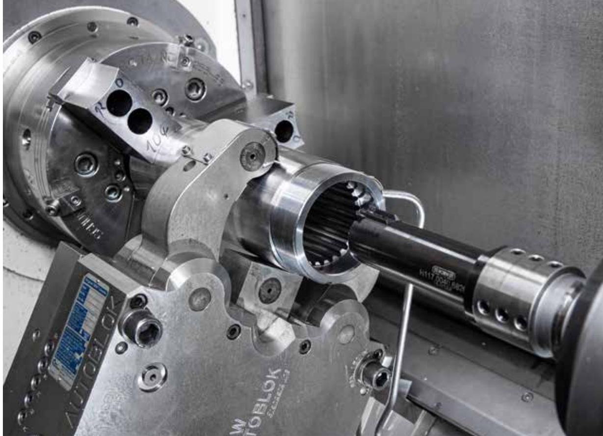
花键的长度在进行插齿加工时需要稳定的刀架。
