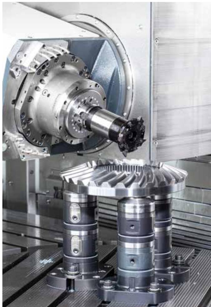
HORN 研发了 M279 铣削系统, 用于经济地粗加工 Zyklo-Palloid 齿轮。
