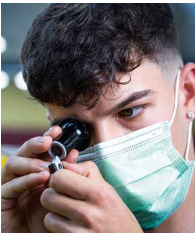
在 22,500 次车槽后检查切削刃。
