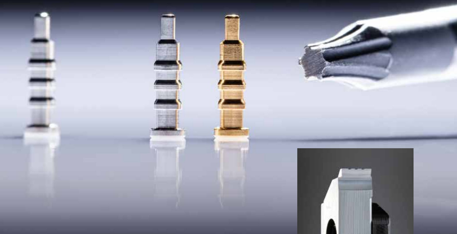
成品部件：左为生产后的部件，右为镀金部件。 图中的 Torx Z7PL 为尺寸参照物。
