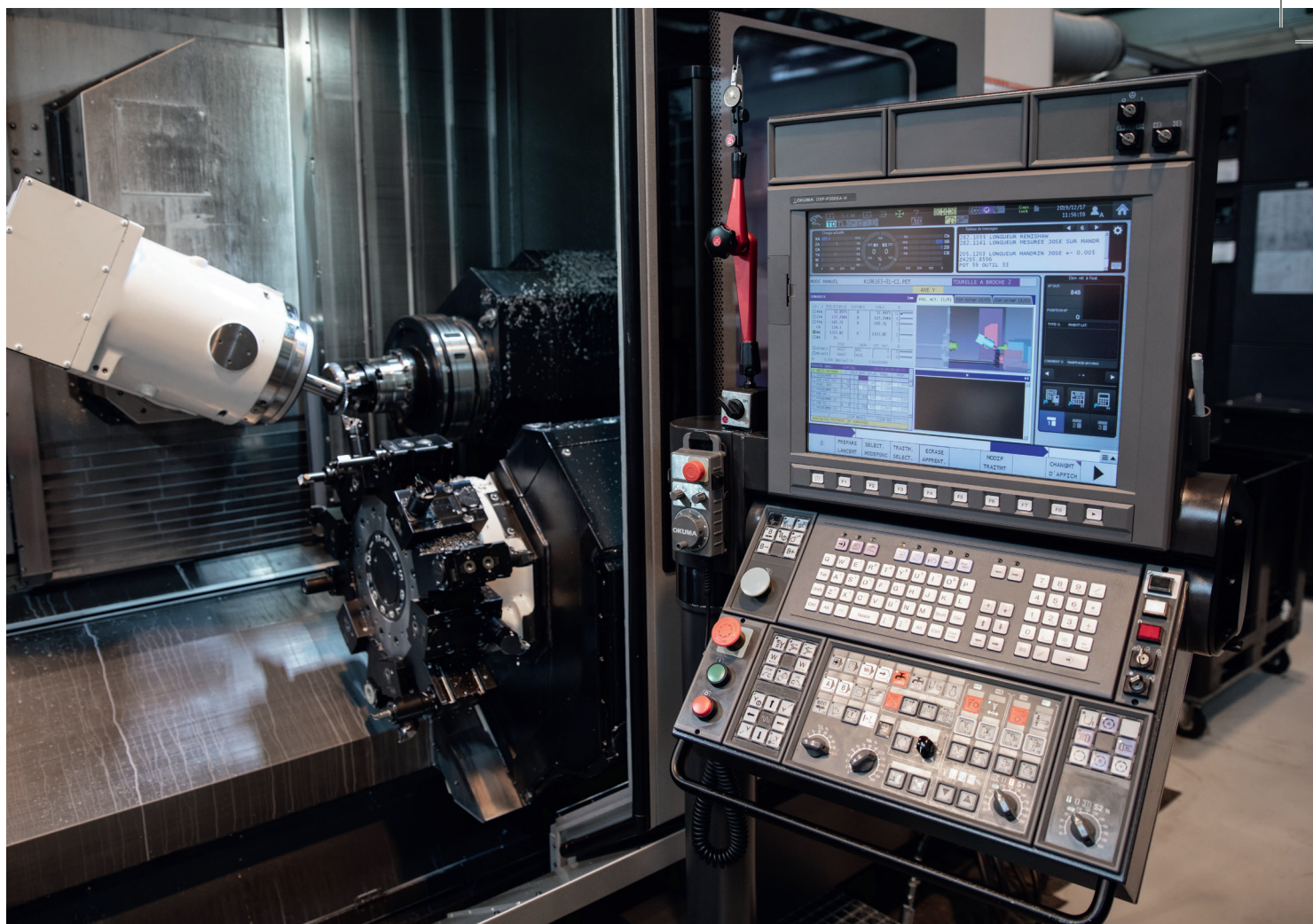
滚动切削可以在现代化加工中心轻松编程。
