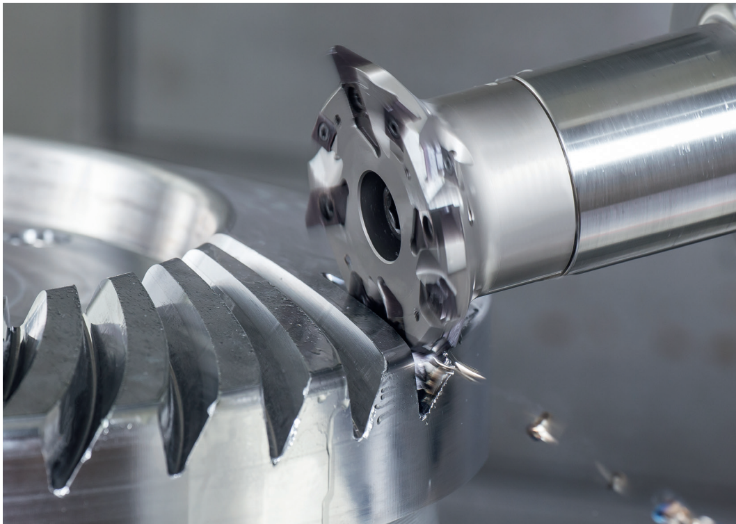
从模块4至模块30, HORN在通用加工中心为样件以及中小批量提供齿部解决方案。
