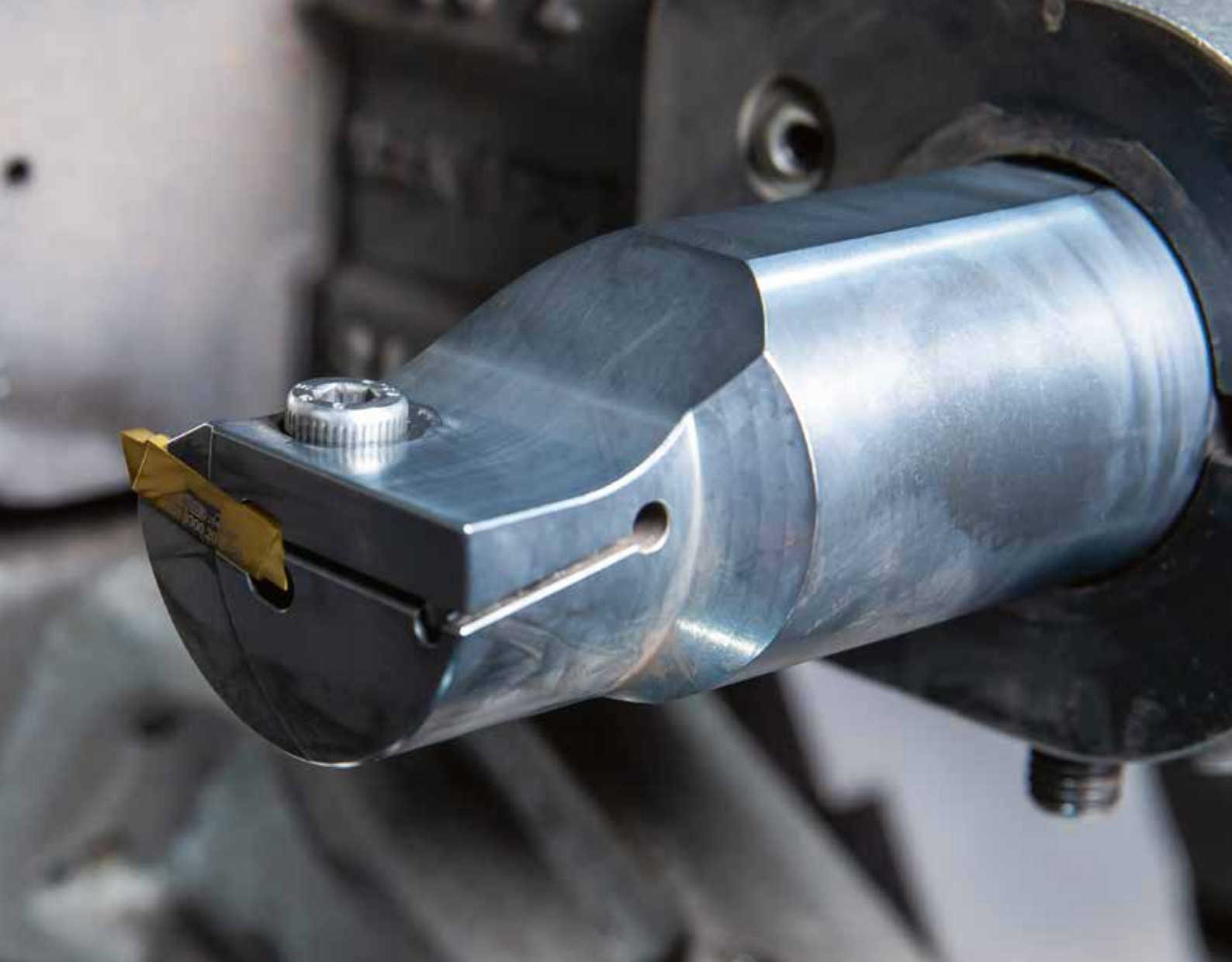
213 型刀夹和 S229 切削刀片。
