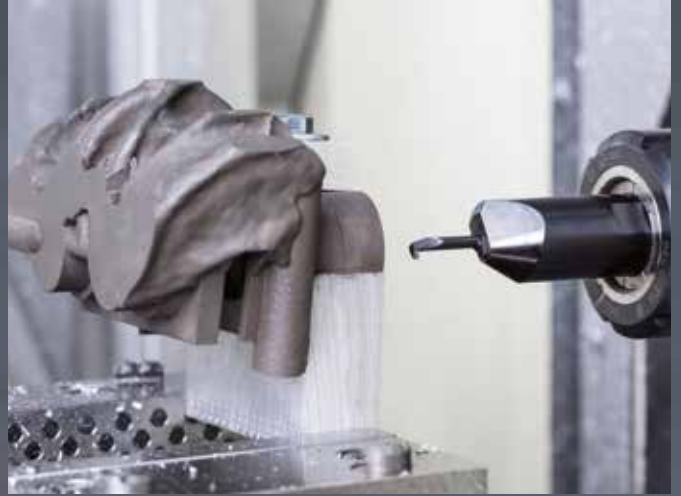
使用 Supermini 105 精镗制动钳。
