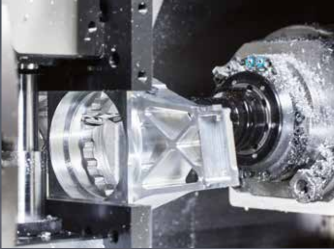
使用 DSA 系统铣削转向节。
