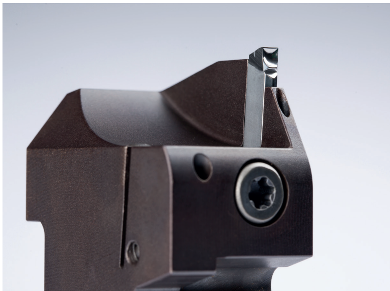
借助抛光的切屑几何形状 WA，铝材加工中的长切屑和堆积边缘问题即可得到成功解决。
