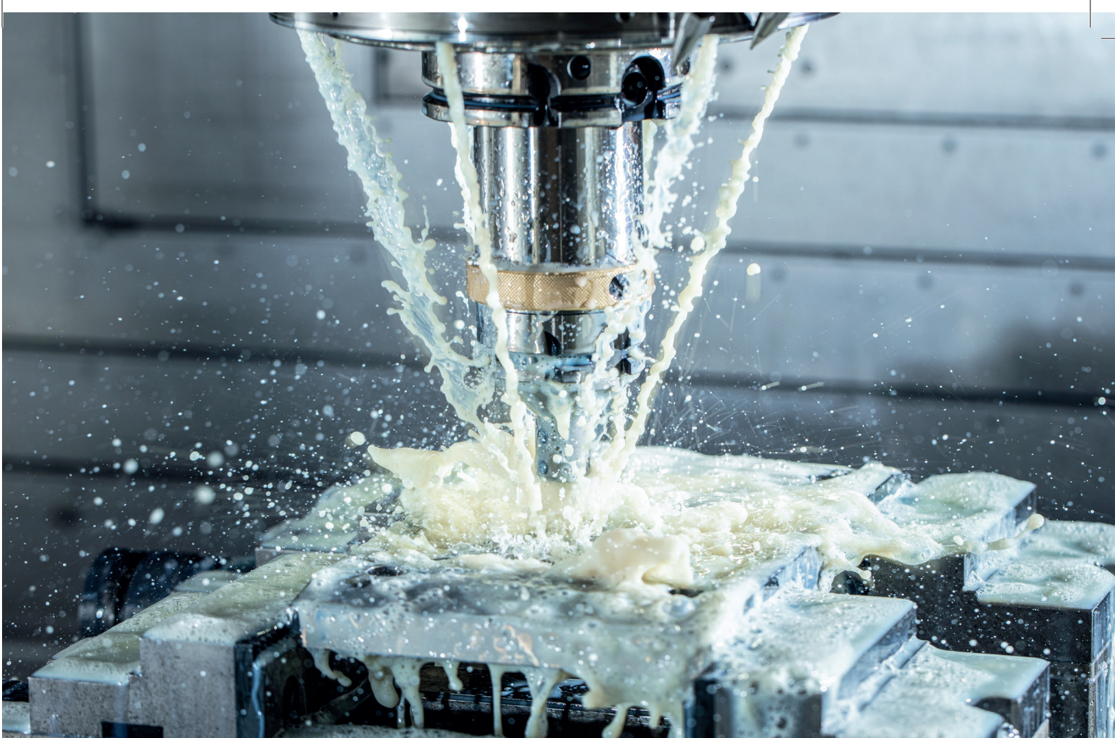
为了在立方工件上高效加工槽，HORN 开发出用于速度成形工艺的刀具。
