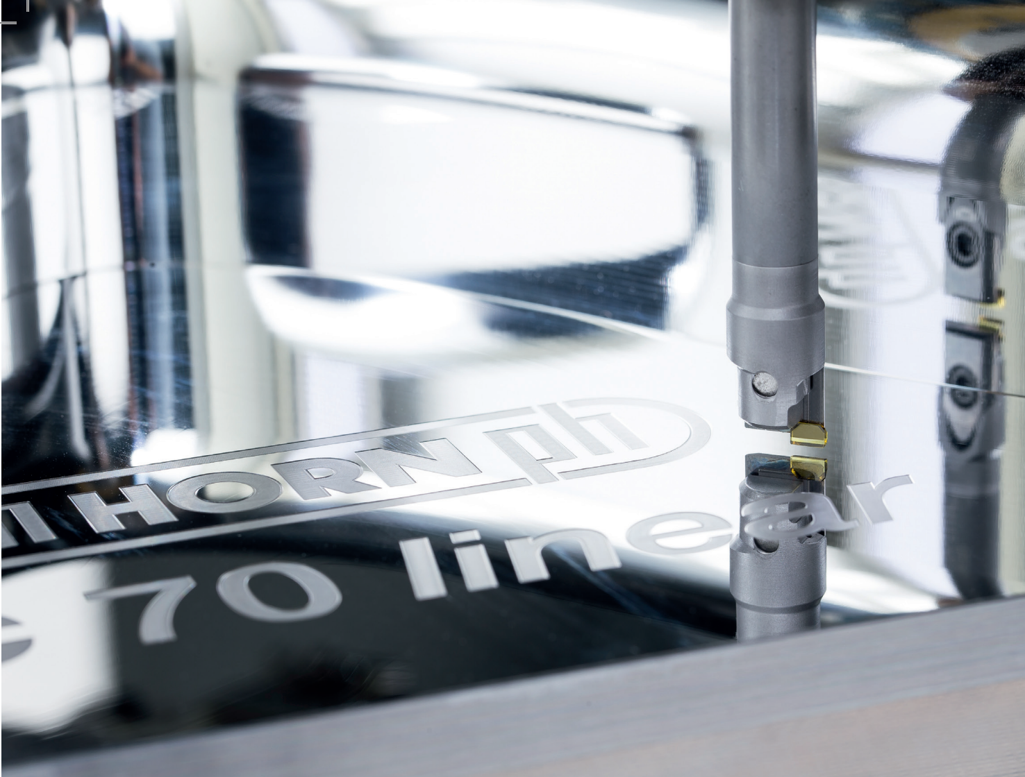
整个表面的镜面抛光处理。通过正弦曲线，HORN 和 DMG MORI 展示出他们在铝材高光加工方面的专业实力。
