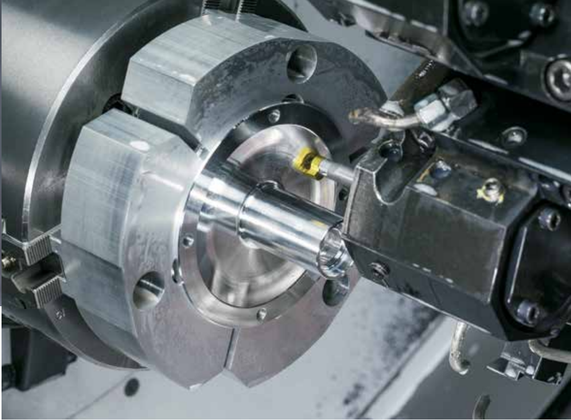
使用 Mini R114 型号的轴向切槽工具对小直径侧面和凹面进行精加工。
