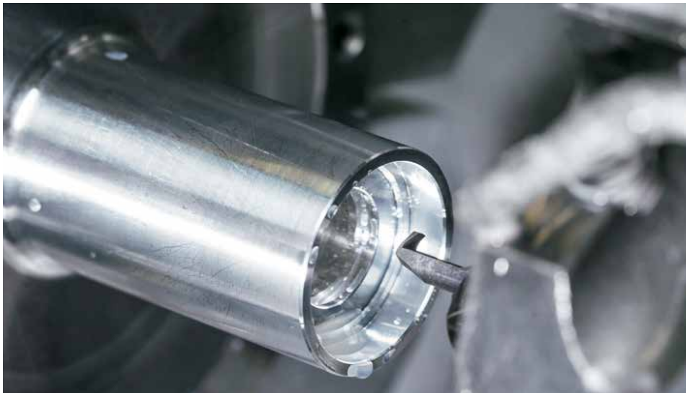
加工 1 mm 宽的内部凹槽时使用 Supermini 105 型号。
