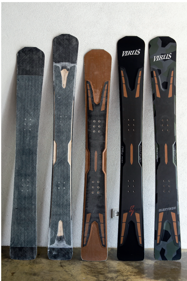
各个生产步骤一览：左侧为层压并经过修整的坯件。右侧为已完成上漆的滑雪板。
