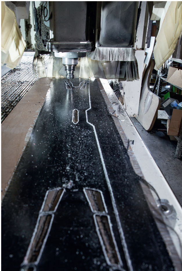
铣削加工 CFRP 垫子。磨损的边缘来自防护织物。
