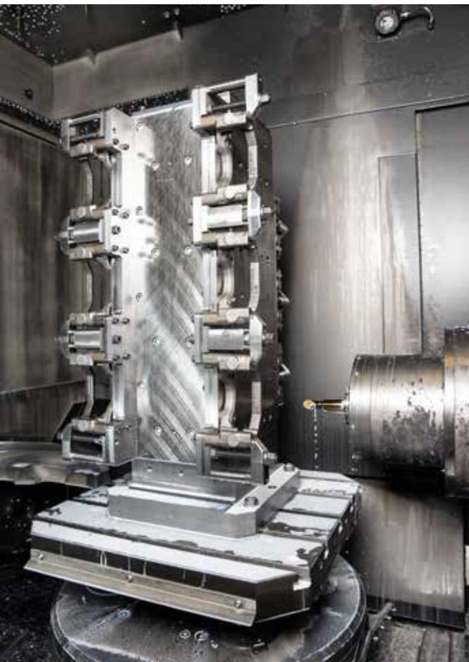
加工时，14 个坯件被夹在一个刀具转塔上。
