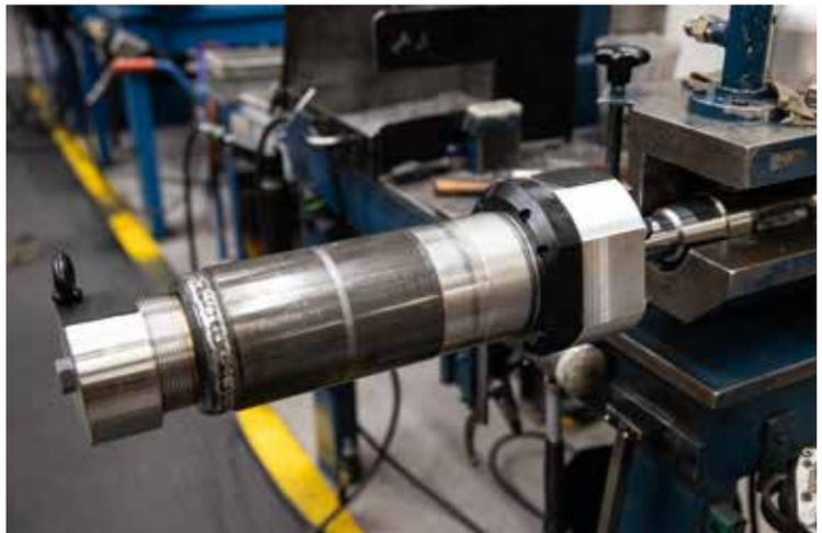
用于滑动底板系统的液压缸的组装。
