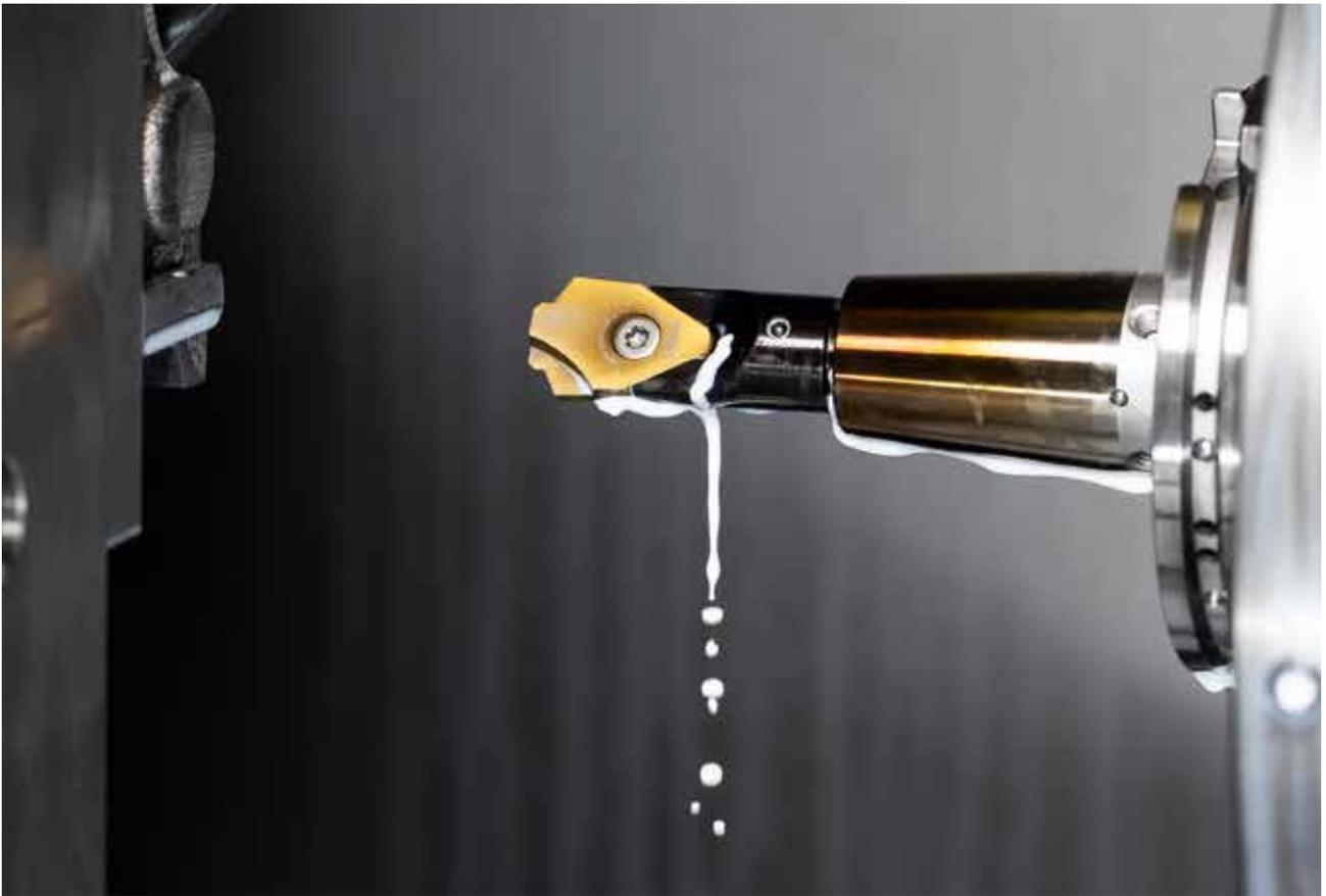
在使用中，D117 成型钻孔刀具现在可以在一道工序中钻出钻孔轮廓。
